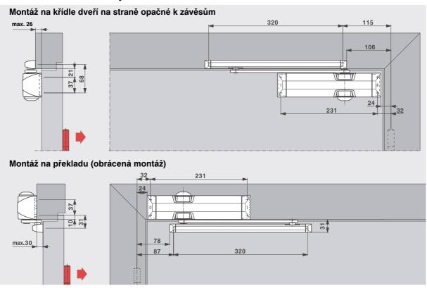
V závislosti na stavebních podmínkách je úhel otevření dveří je omezena na cca. 95°. Doporučujeme použít omezovač otevření dveří nebo dveřní zarážku.
