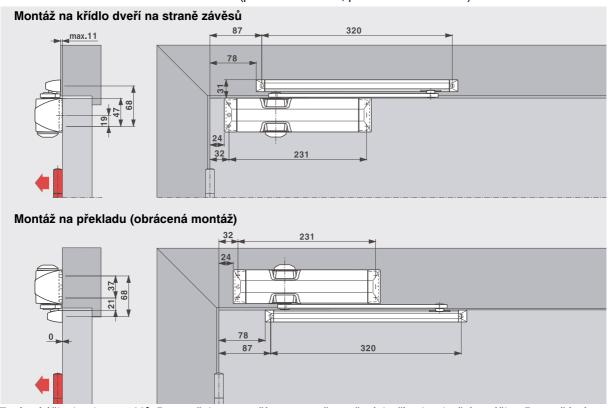
Zavírací účinek od cca. 160°. Doporučujeme použít omezovač otevření dveří nebo dveřní zarážku. Pro požární a kouřotěsné dveře je nutné použít dveřní zarážku.
