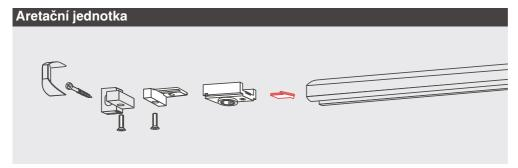
Aretační jednotka umožňuje přesné zajištění dveří bez zpětného pružení až do úhlu otevření cca. 145°.
