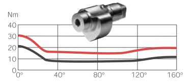
Srdcová vačka a lineární náhon DORMA TS 90 Impulse zajišťují snadné ovládání dveří díky rychle klesajícímu otvíracímu momentu. Proto nemají ani děti, starší osoby nebo tělesně postižení žádné problémy při otvírání dveří. Uživatelsky
