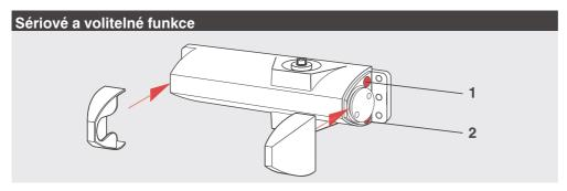
Rychlost zavírání u DORMA TS 90 Impulse je plynule nastavitelná pomocí ventilů ve dvou vzájemně nezávislých oblastech.
